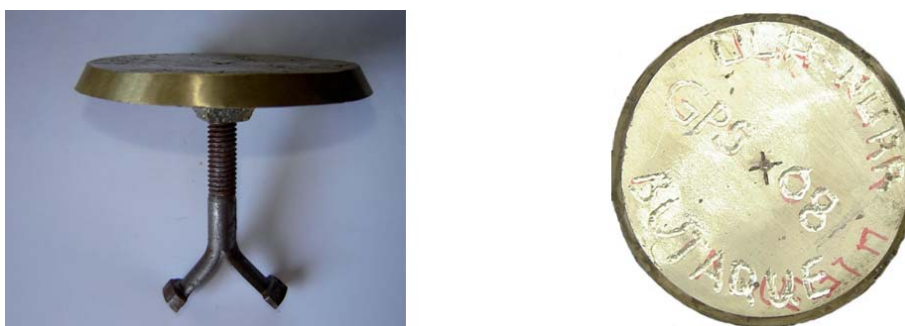
Foto 8. Ilustración de placas con descripción de ubicación del control geodésico
