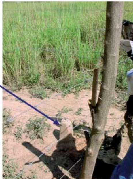
Foto 1. Punto de control de la poligonal dentro del Asentamiento Campesino Las Cocuizas- EL Macoyal. Parroquia La Paz. Municipio. Pampán.
