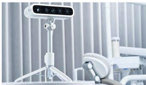
Figura 1. Escáner facial Metismile utiliza inteligencia artificial para analizar la cara del paciente y crear un modelo digital ayuda a planificar tratamientos personalizados de manera más eficiente y precisa
