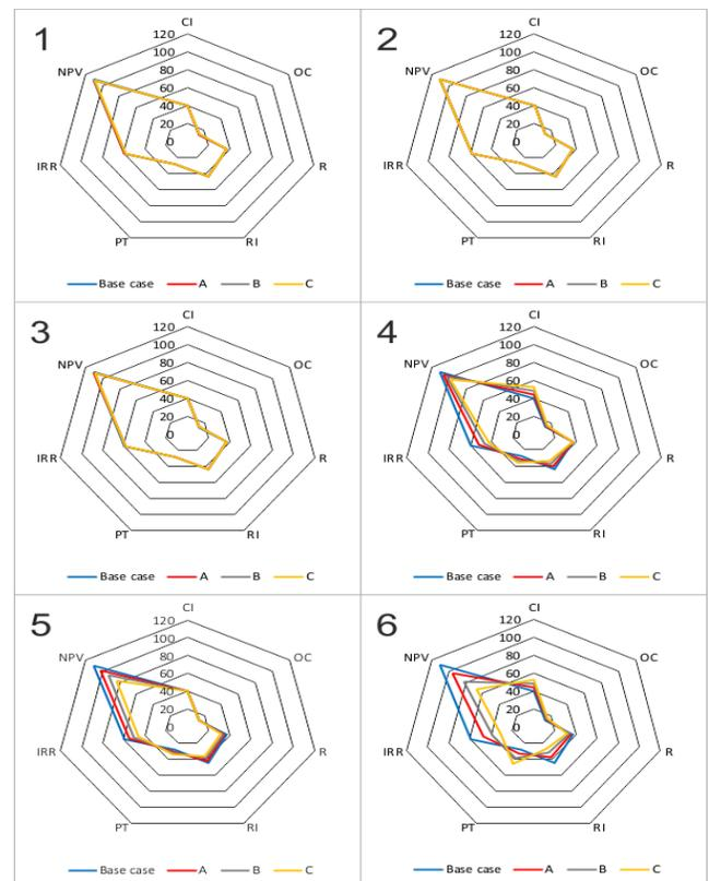
**Fig. 6:** Análisis de sensibilidad para el proceso de producción de ácido láctico con bagazo de caña como materia prima; parámetros a evaluar: 1. Materia prima, 2. Consumibles, 3. Utilidades, 4. Equipos, 5. Ácido láctico, 6. Análisis combinado.
