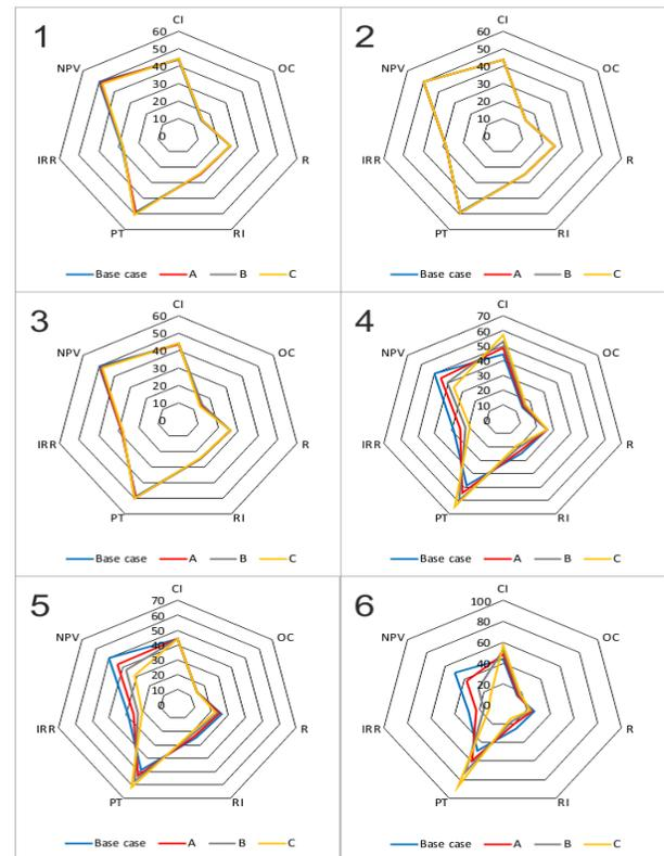
**Fig. 5:** Análisis de sensibilidad para el proceso de producción de ácido láctico con cascarilla de arroz como materia prima; parámetros a evaluar: 1. Materia prima, 2. Consumibles, 3. Utilidades, 4. Equipos, 5. Ácido láctico, 6. Análisis combinado.
