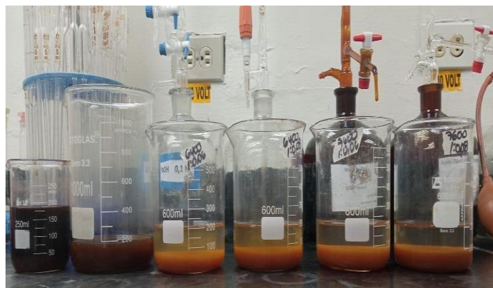
Fig. 1: Aplicación del proceso Fenton a una muestra del efluente residual proveniente de planta de pulpa.
