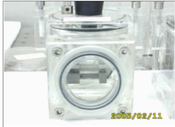
**Figura 1:** Celda de plexiglas utilizada para la medición de ángulos de contacto.
