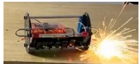
Fig. 23. Prueba de encendido de cerillo eléctrico para la chispa de ignición del cohete desde la estación terrena. Fuente: Elaboración propia.
