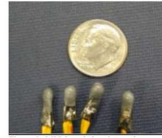
Fig. 21. Cerillo eléctrico utilizado para la ignición del combustible. Fuente: (Son y cols; 2002).
