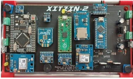
Fig. 13. Construcción de la Computadora de vuelo. Fuente: Elaboración propia.
