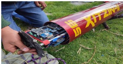
Fig. 33. Cohete experimental XITZIN II con la computadora de vuelo construida. Fuente: Elaboración propia.
