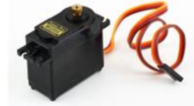
Fig. 10. Servomotor MG-995 controlado por PID utilizado como control de los alerones para el control del vuelo. Fuente: Elaboración propia.
