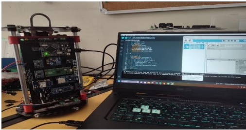
Fig. 32. Programación del Arduino Mega con el programa principal de la computadora de vuelo. Fuente: Elaboración propia.
