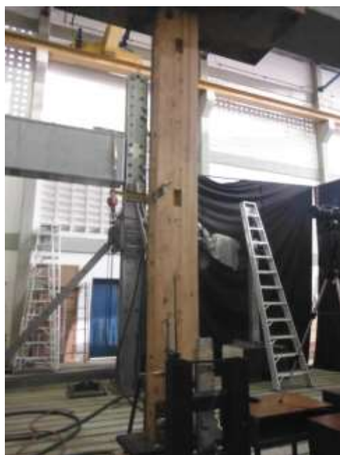
FIGURA 5. Elemento portante al inicio del ensayo.
