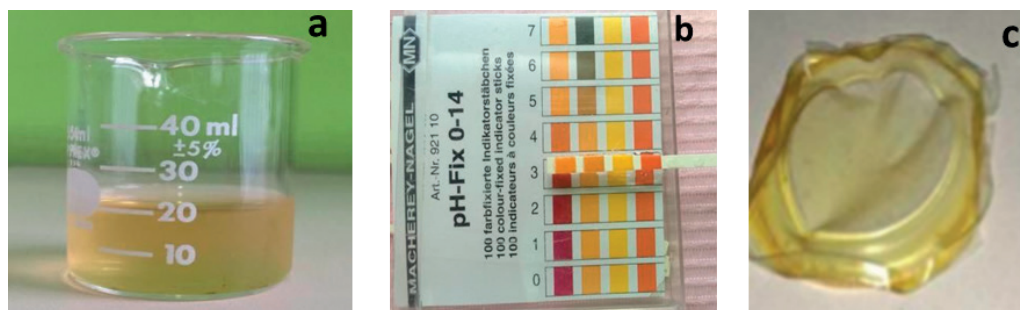
FIGURA 1. Gel de Quitosano y película de Dxm/Q. a) Gel de quitosano; b) pH del gel de quitosano y c) películas de Dxm/Q
