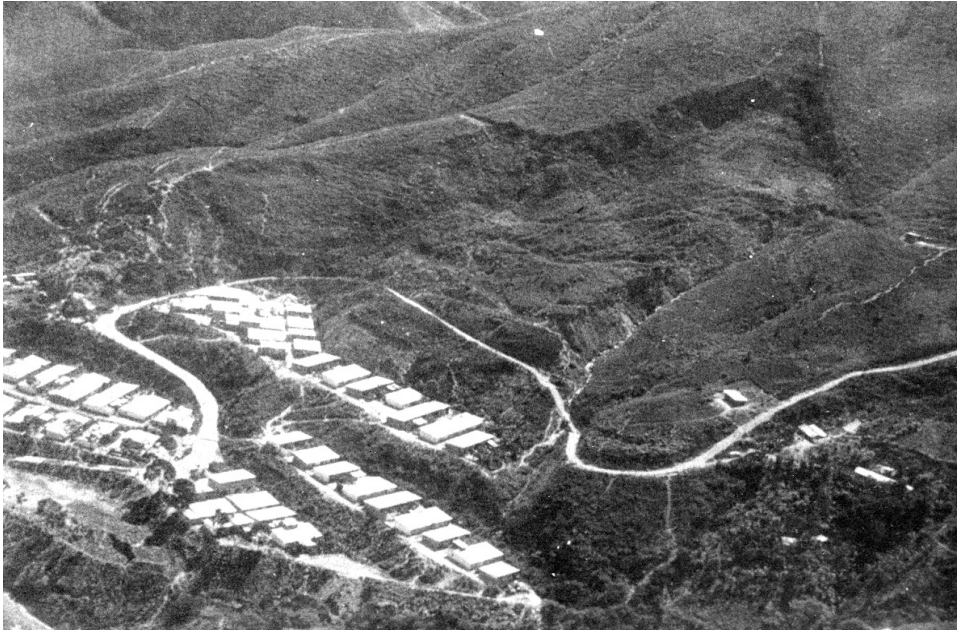
Figura 5. Vista lateral del deslizamiento llamado "Corral de Piedra", Urb. Kennedy (Las Adjuntas, carretera vieja de los Teques, Caracas - Venezuela). Se puede observar claramente las estructuras de las edificaciones reubicadas en la masa deslizada de un antiguo movimiento (fotografía tomada por A. Singer, en enero de 1975). Fuente: Singer A., 1983, pág. 54
