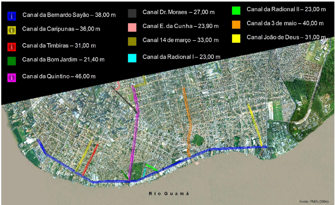
FIGURA 5. Faixa de domínio de canais – de acordo com o PDU (Lei 7.603 de 13 de janeiro de 1993) e o CFB (Lei n° 4.771 de 1965).
