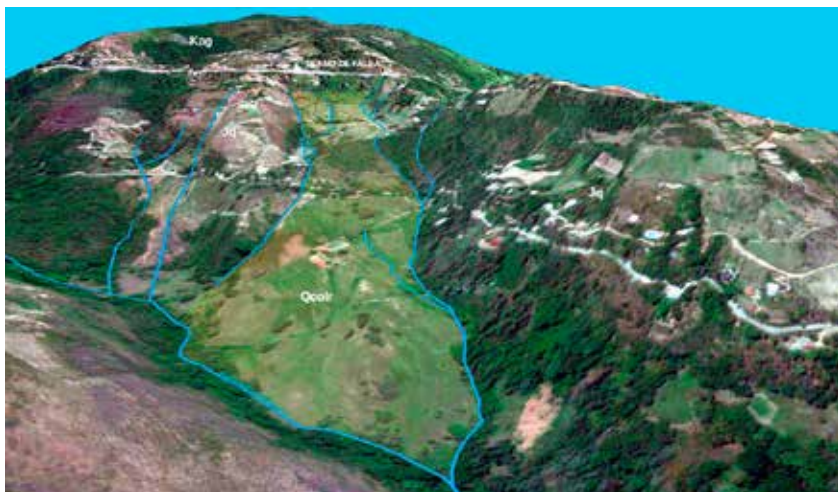
FIGURA 9. Modelo de elevación digital. Se puede apreciar el depósito sedimentario de la avalancha de rocas
