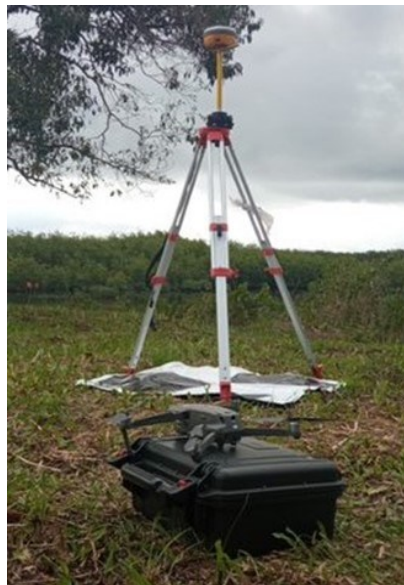
FIGURA 2. RPA DJI Mavic 2 Pro e receptor GNSS sob ponto de controle
