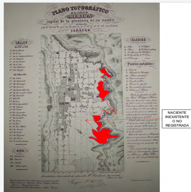
Figura 03.- la diferencia entre contornos del talud de la foto aérea y el del plano representa los derrumbes ocurridos (áreas rojas que sobresalen del contorno de la foto aérea).
