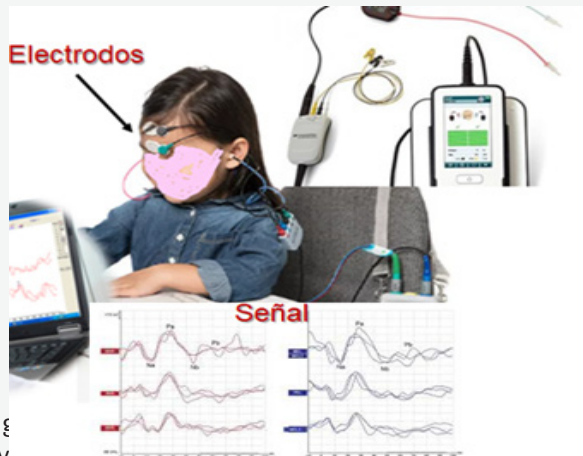
Figura 17.- Implementación de evaluación mediante potenciales evocados somatosensoriales
