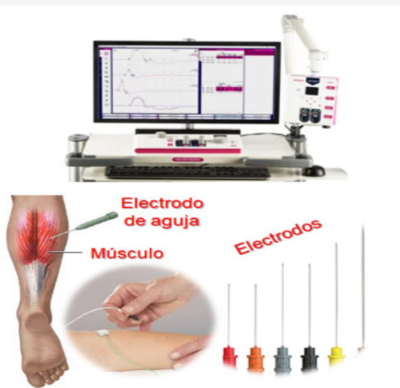
Figura 13.- Arreglo para el estudio de Electromiografía
